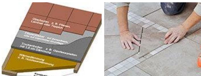
Abbildung 8: links: Aufbau eines Bodens, © BZB e. V., rechts: sorgfältiges Arbeiten, © GreenHouse
